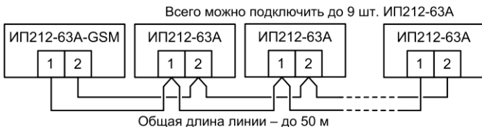
Рис.6 Схема соединения извещателей в группу
